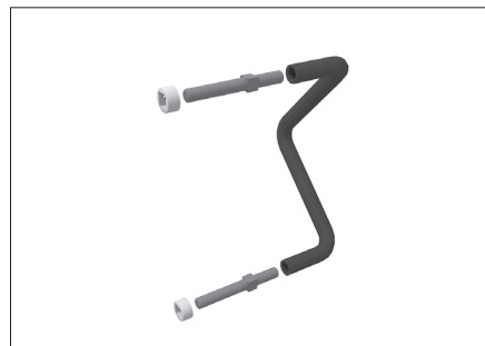
На квадратную часть винта наденьте гайку.
