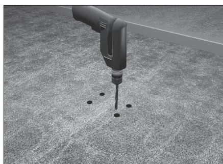
Просверлите 4 отверстия \varnothing 13 в дорожном покрытии.
